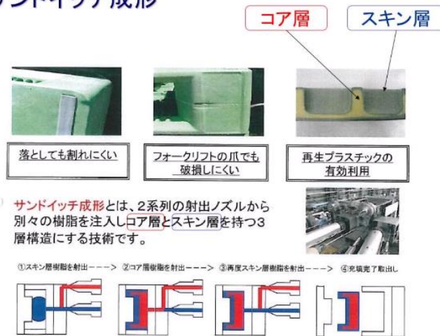
図 23：明治ゴム化成の配合技術を駆使したサンドイッチ成形 (コア層に再生樹脂を使用することで環境配慮とコストダウンを同時に実現)
