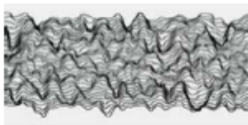
<表面粗さの3次元プロファイル>
